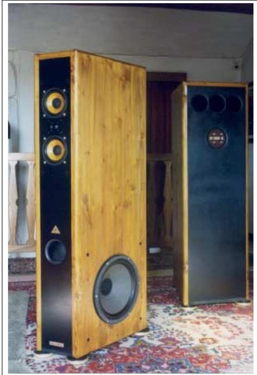
Si tratta di un sistema di diffusione facente uso di quattro altoparlanti per ciascun canale, ma la sua configurazione è parzialmente anticonvenzionale.
