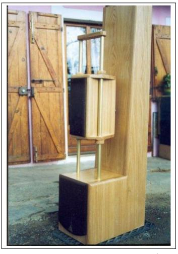
Il mobile trapezoidale, riempito con fonoassorbente in pura ovatta di cellulosa, riduce al minimo la formazione di onde stazionarie, migliorando la trasparenza e la risposta ai transienti.
