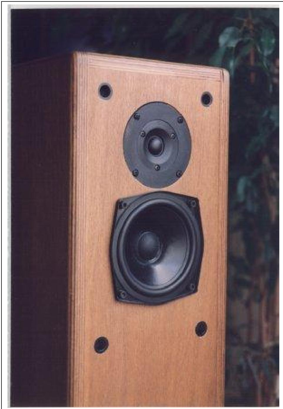
**Il woofer** è un componente da 13 cm di diametro, dotato di un bellissimo cono ad alta rigidità in carta trattata con speciali collanti, molto buona è pure la sua escursione che gli consente perciò di riprodurre discrete potenze acustiche anche a frequenze molto basse.
